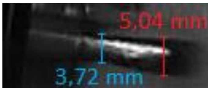
Obrázek 4 Maximální průměr D_{\max} u jednotné dočasné dutiny a minimální průměr D_{\min} dočasné dutiny u 1. střely při vzdálenosti střelby X = 500 cm
