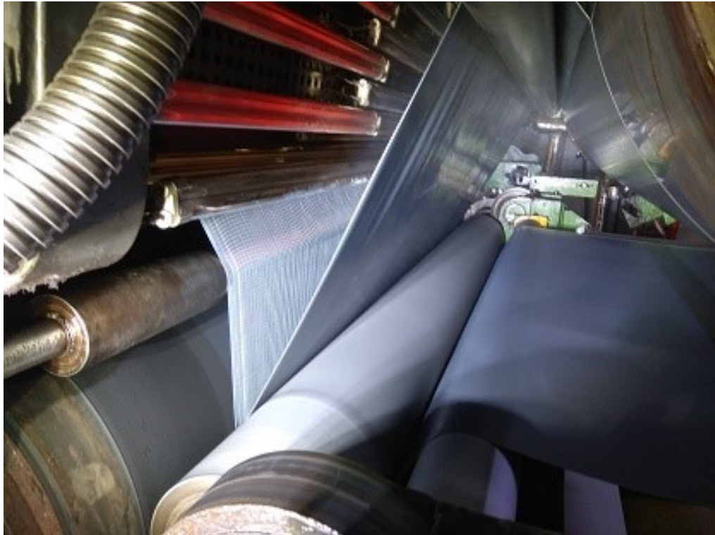
Obr. 23: Infra zářiče a přítlačný laminační válec [26]
