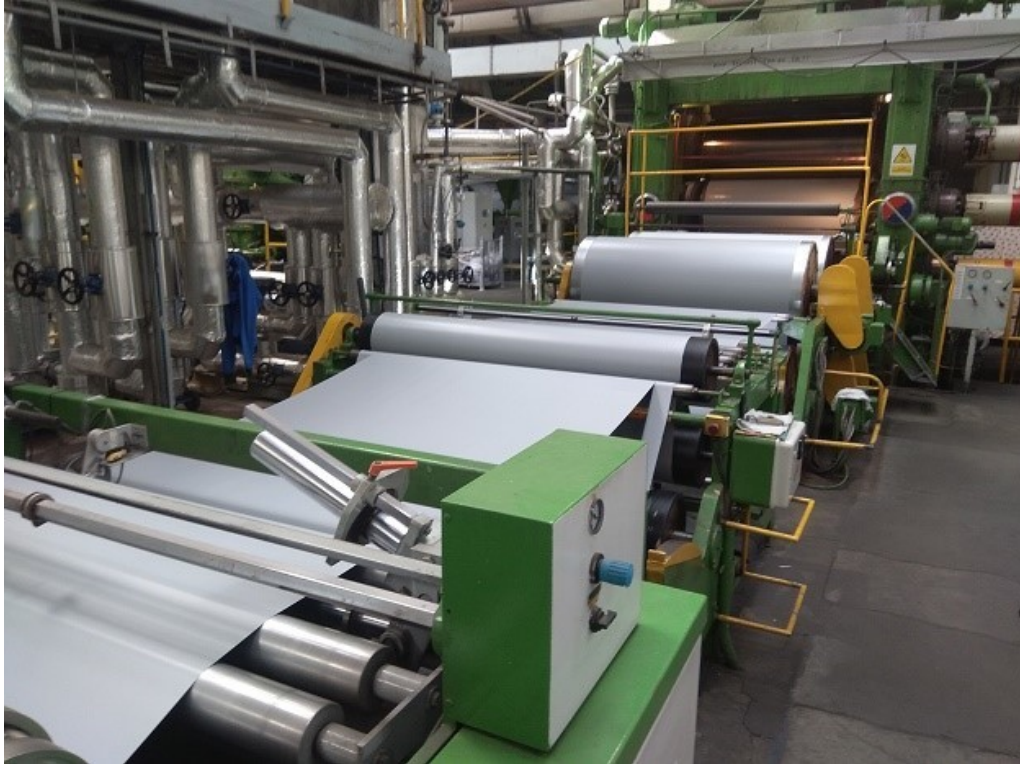
Obr. 21: Navijecí systém válců na lince COM 3 – polotovar obsahující ZnO a DCOIT [26]
