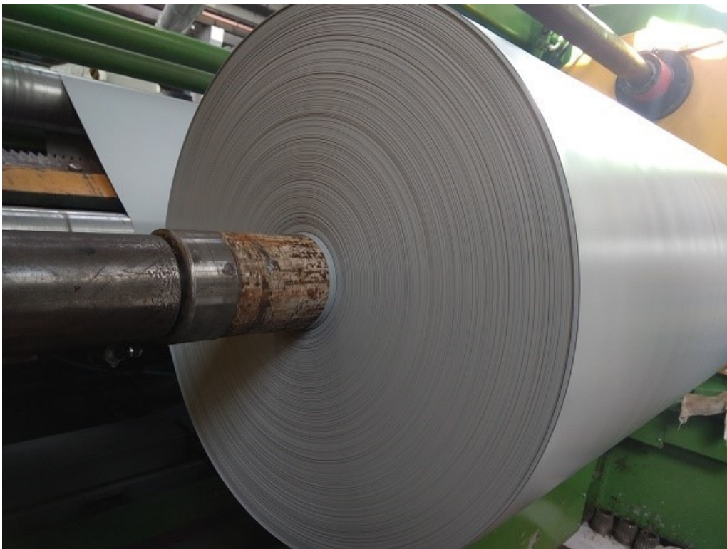
Obr. 22: Polotovar obsahující ZnO a DCOIT, návin 0,51 mm tloušťky, šířka 1400 mm [26]
