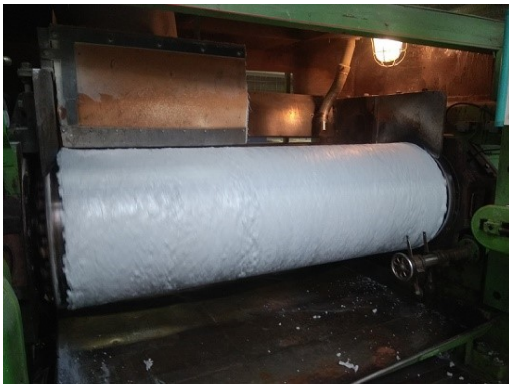
Obr. 19: Dvouválec na válcovací lince COMERIO 3 – směs obsahující ZnO a DCOIT [26]
