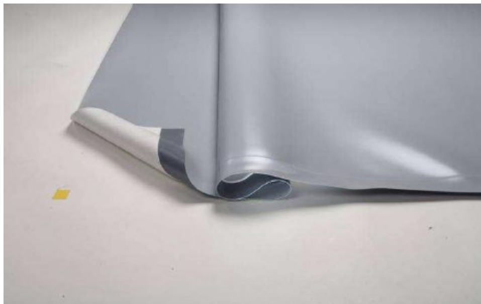
Obr. 4: Hydroizolační fólie bez PES mřížky [2]
