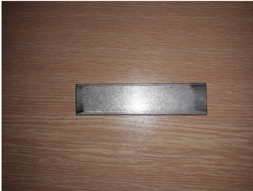
Obrázek 10 - Zkušební těleso obdélníkového průřezu
