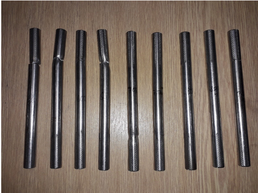
Obrázek 30 - Porušená tělesa po provedení cyklické zkoušky
