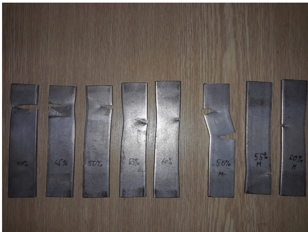
Obrázek 26 - Porušená tělesa po provedení cyklické zkoušky
