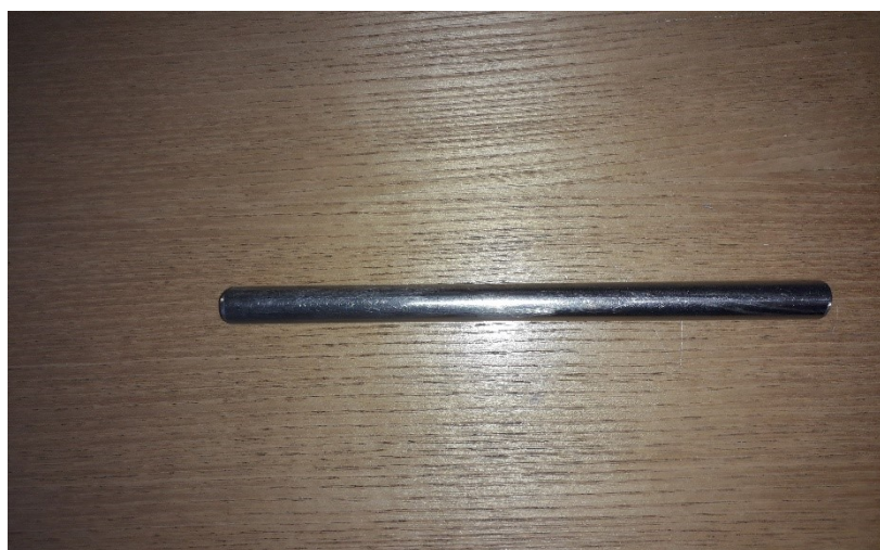
Obrázek 9 - Zkušební těleso kruhového průřezu
