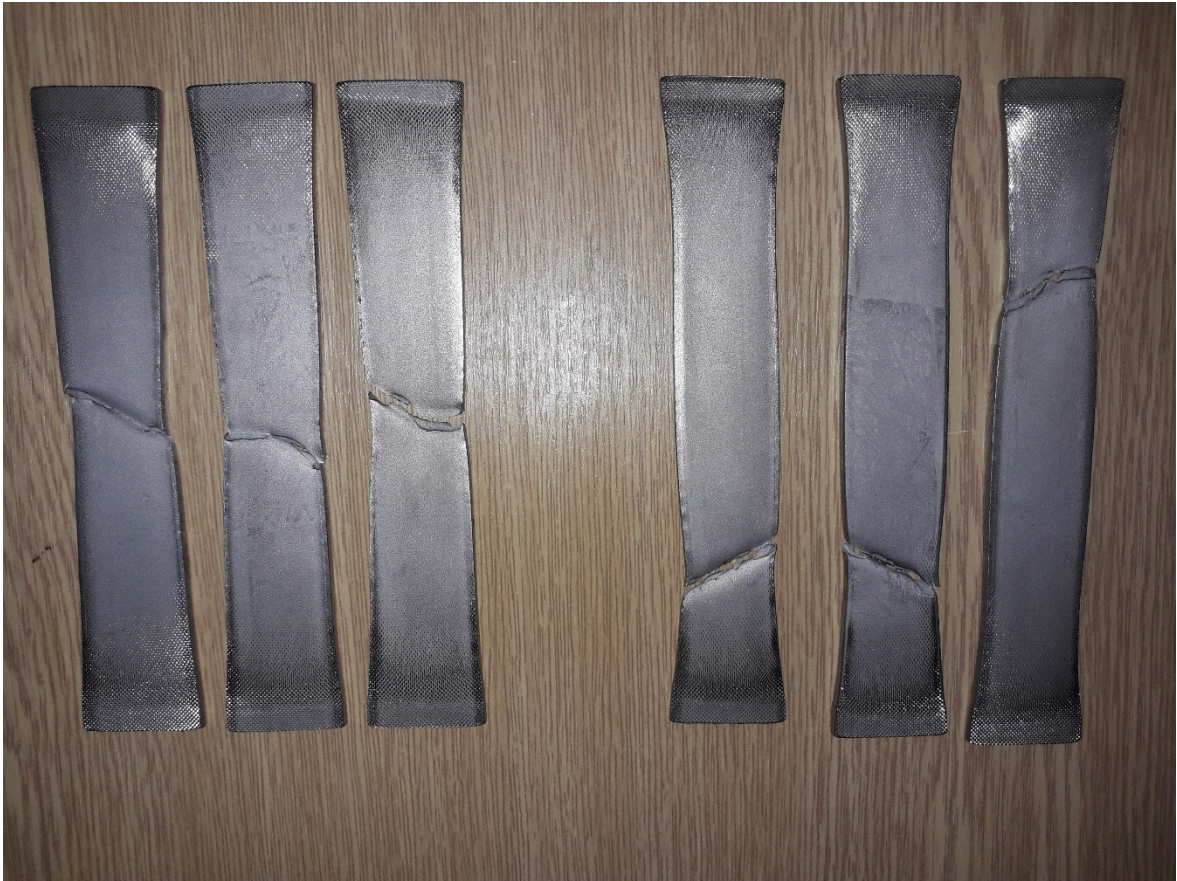
Obrázek 15 - Přetržená tělesa obdélníkového průřezu po tahové zkoušce – vlevo jsou tělesa zkoušená při teplotě 20°C, vpravo při -30°C
