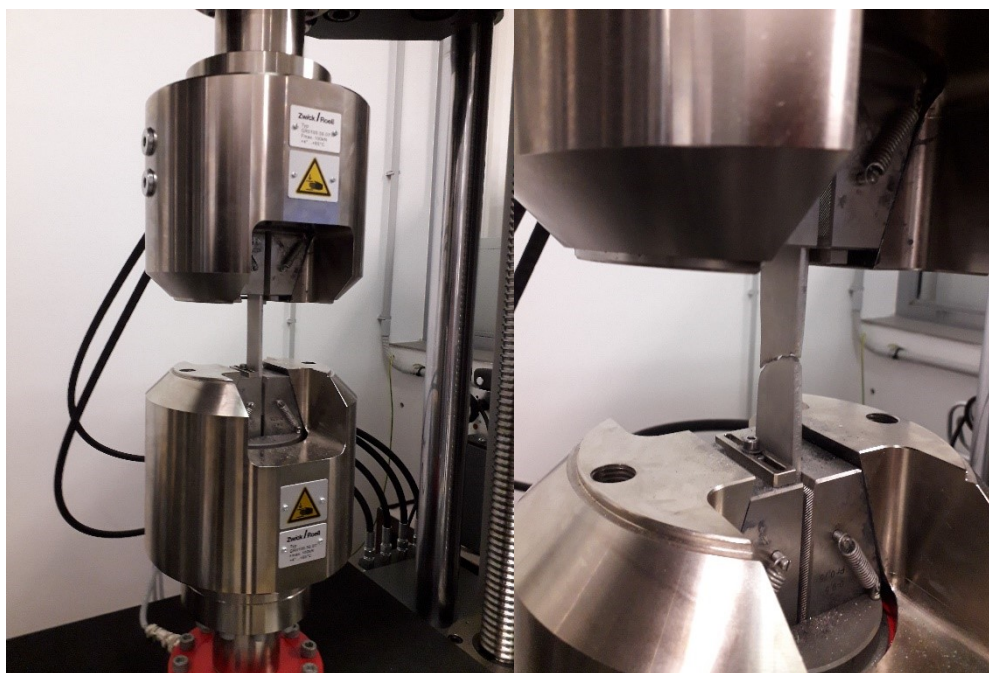
Obrázek 12 - Zkoušené těleso před a po přetržení
