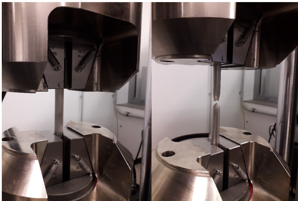
Obrázek 16 - Zkoušené těleso před a po přetržení
