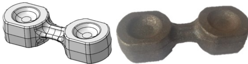
Obr. 30 3D model výkovku (vlevo) a skutečný výkovek (vpravo)
