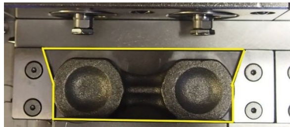
Obr. 37 Detail založení výkovku ve stroji
