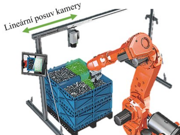
Obr. 46 Běžné řešení bin pickingu s lineárním posuvem kamery podél bedny [2]
