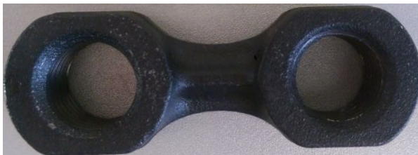
Obr. 61 Výkovek s vyfrézovanými závity
