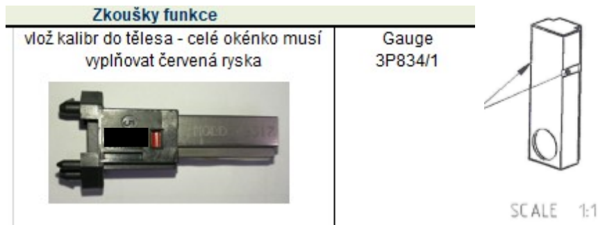
Obrázek 36 Kontrola kalibrem 3P834 (interní materiály společnosti)
