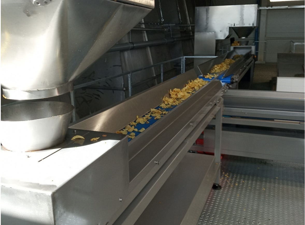
Obrázek 30: Dopravní pásy od výtahů (interní zdroje)
