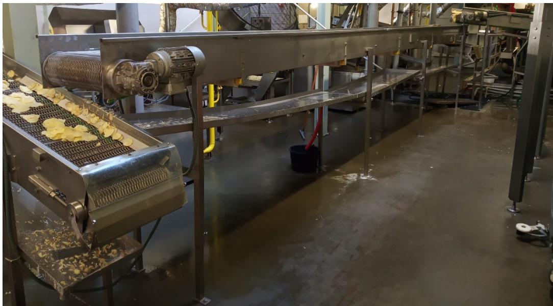
Obrázek 18: Dopravní pás zásobující 3. fritézu (interní zdroje)
