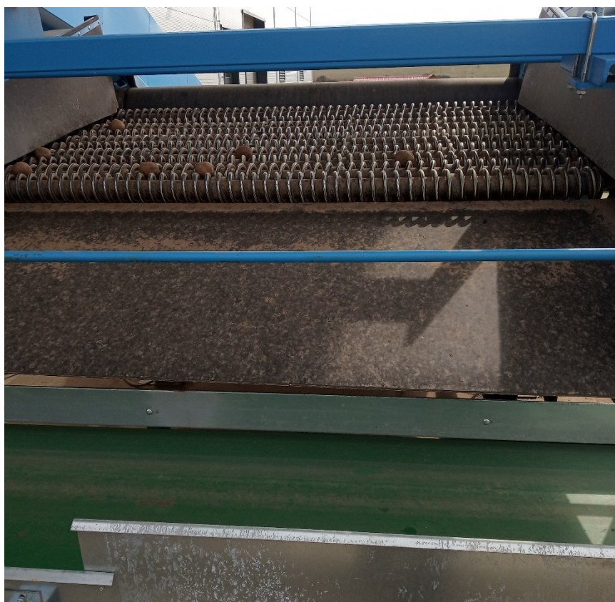
Obrázek 28: Stroj na očištění brambor (interní zdroje)
