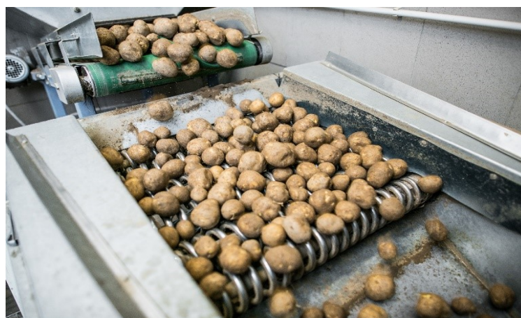
Obrázek 16: Stroj na očištění brambor (interní zdroje)
