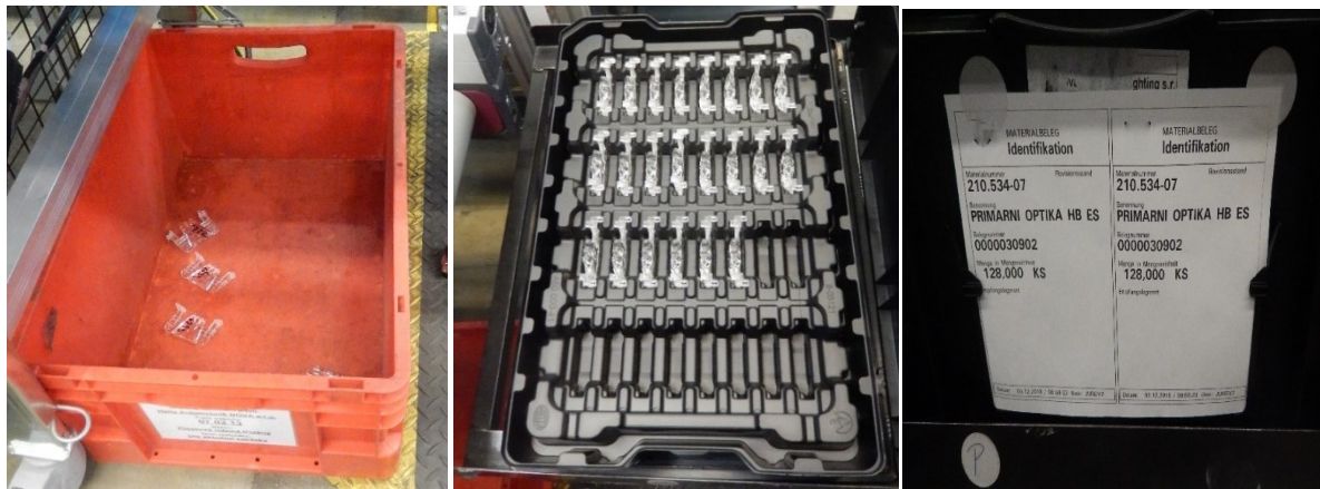
Obr. 18: Bedna na zmetky, blistr s vyliisovanými díly a průvodka (Vlastní fotografie)
