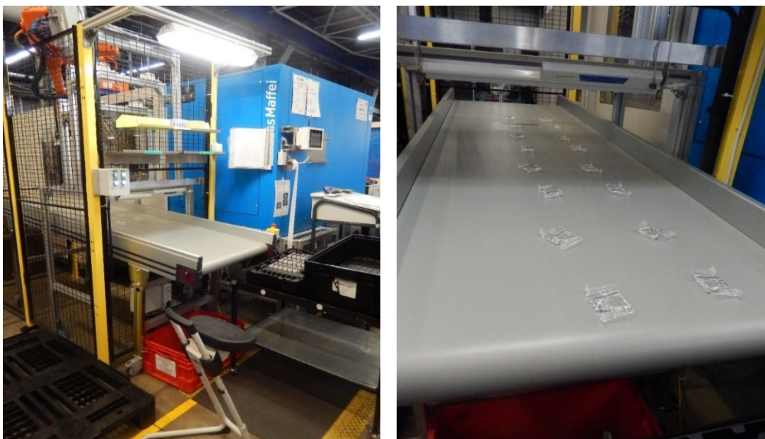
Obr. 17: Pracoviště vstřikovacího lisu, vylisované díly na dopravníku (Vlastní fotografie)
