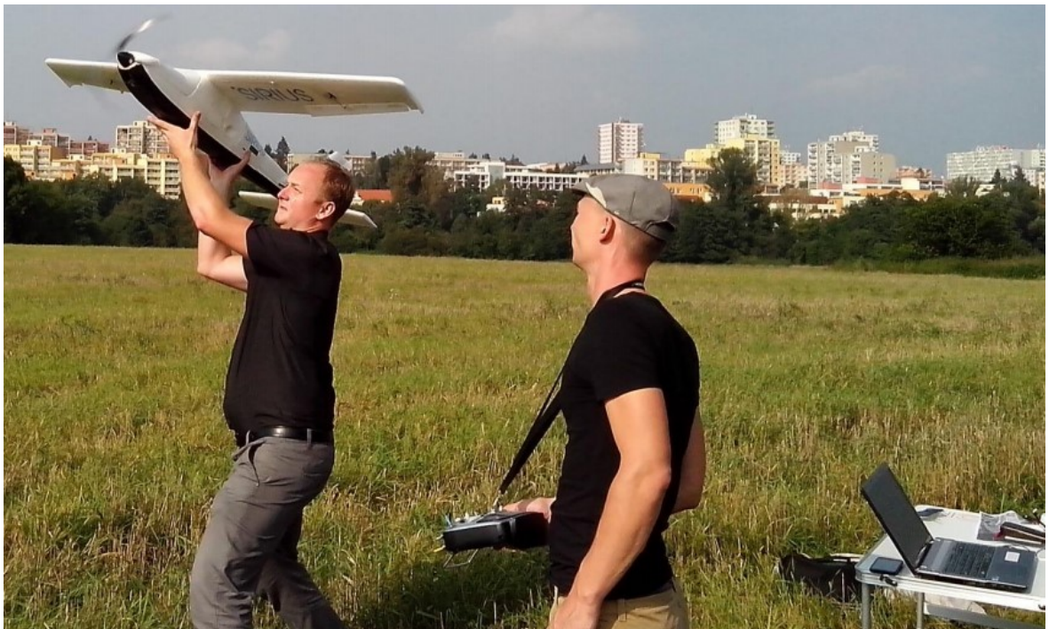
Obr. 8: Vzlet UAV hodem z ruky do vzduchu [50]
