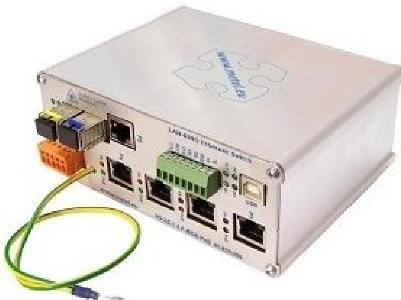
Obr. 57. Kamerový switch s PoE [30]
