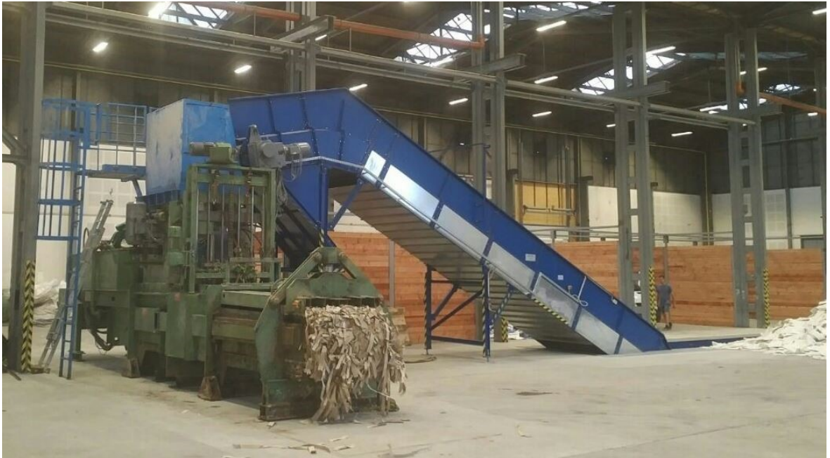
Obrázek 9 – MAD Recycling Česká republika a.s. - paketovací lis a dopravník [zdroj: vlastní]
