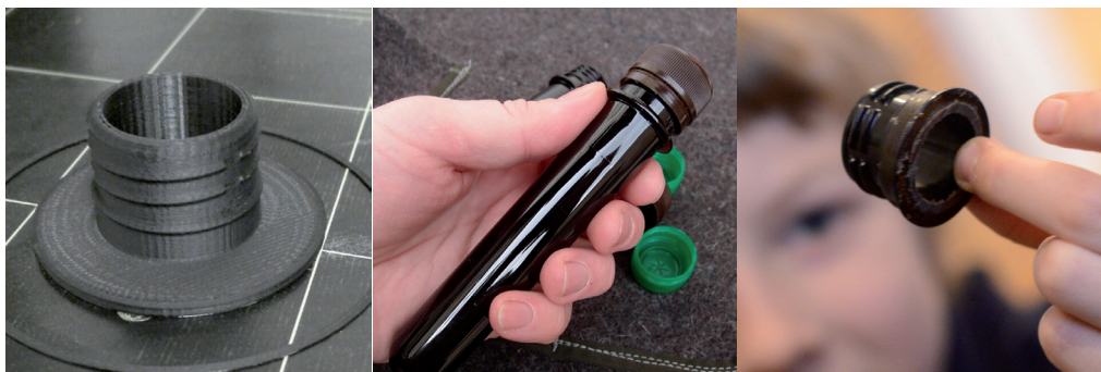
Obr. č. 45, 46, 47: Zleva: 3D výtisk – prototyp šroubu, Preforma, uřezaný šroub z preformy
