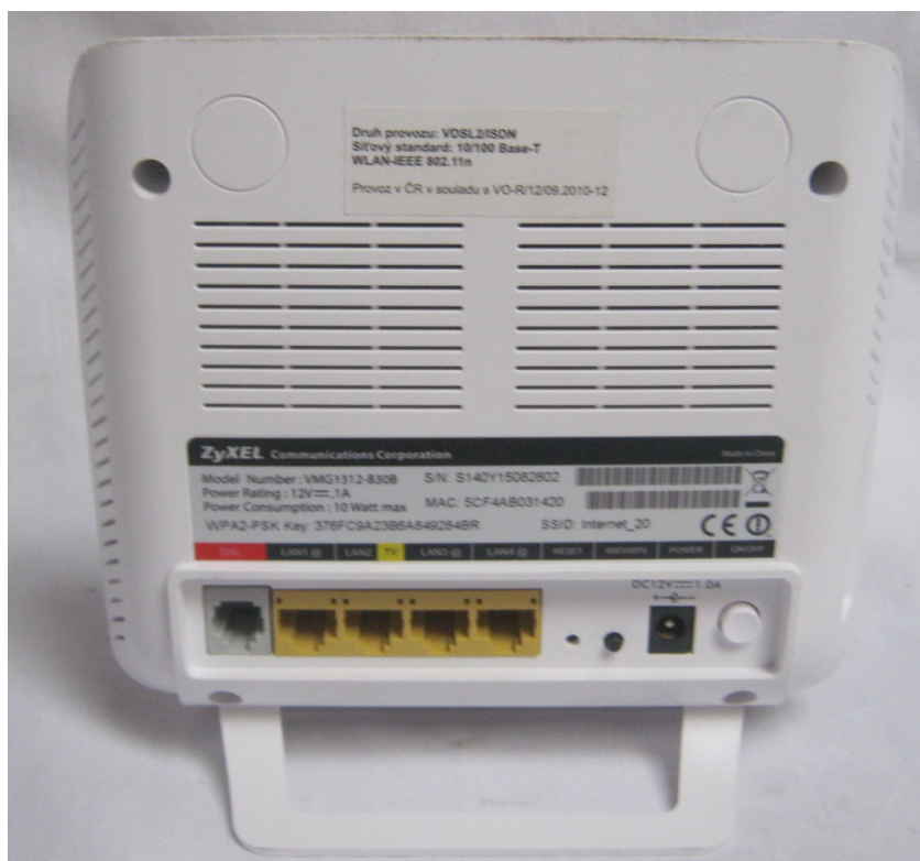
Obr. 13. VDSL router ZyXel VMG1312 s integrovaným čtyřportovým switchem.
