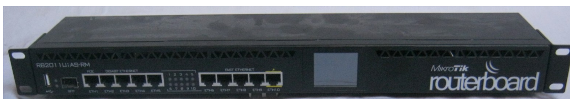
Obr. 30. Router Mikrotik RB2011UiAS-RM.
