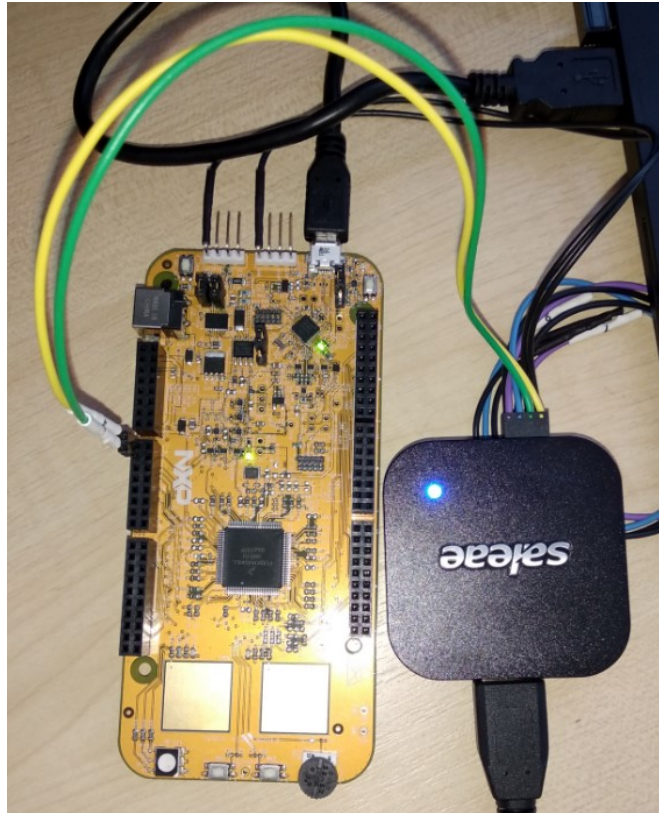
Obr. 24: Měření toku dat na Rx a Tx pinech
