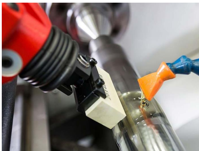
Obr. 33. Superfinišování hřídele kamenem [23]
