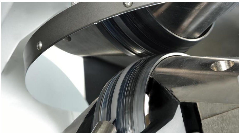
Obr. 61. Magnetoreologické dokončování zrcadla [39]
