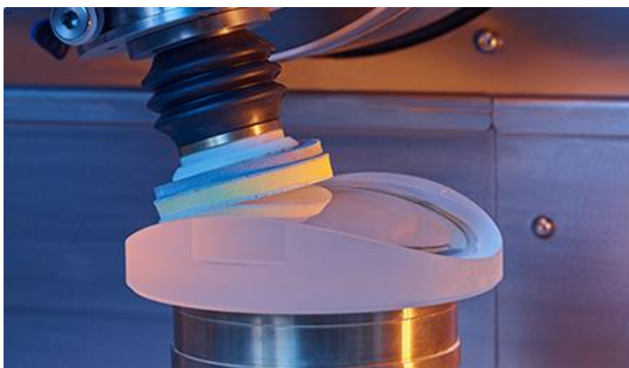
Obr. 45. Leštění skla [28]
