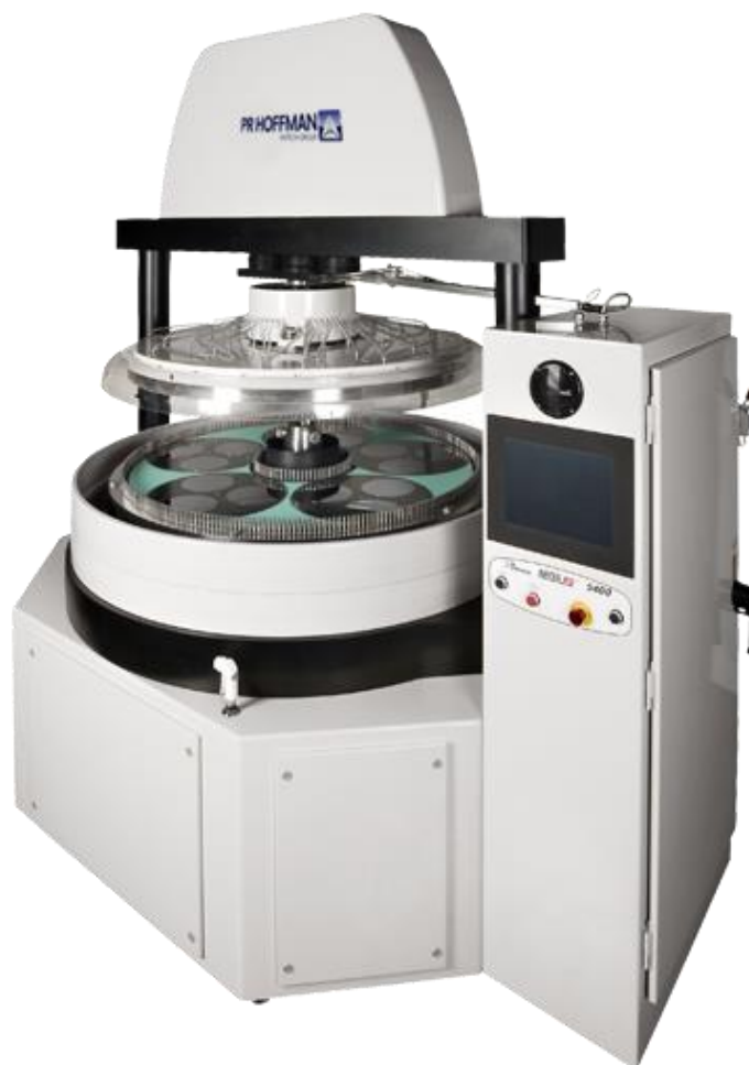
Obr. 29. Dvoukotoučový lapovací stroj [21]
