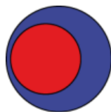
Obr. 4 Průřez vláknem typu „excentrický plášť/jádro“. [17]
