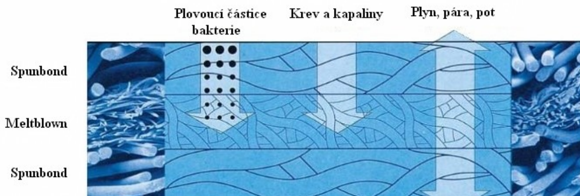
Obr. 13 Třívrstvá netkaná textilie a její propustnost částic. [33]
