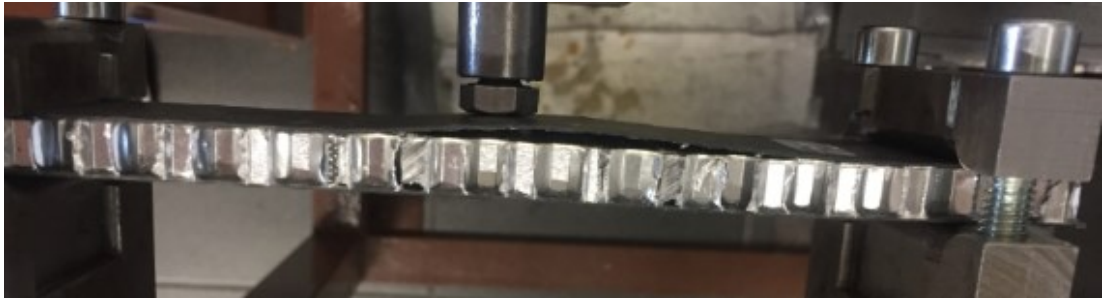
Obr. 58. Porucha sendviče s potahem z uhlíkového prepregu na 2. hladině zatížení
