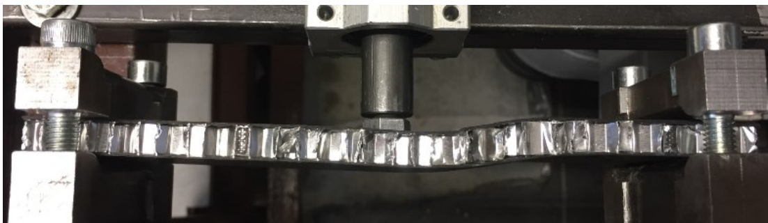
Obr. 61. Porucha sendviče s potahem z uhlíkového prepregu na 4. hladině zatížení
