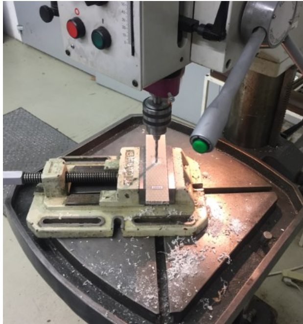
Obr. 42. Vrtání díry pro insertovou vložku
