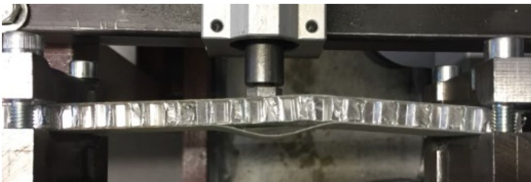
Obr. 57. Porucha sendviče s potahem ze skelného prepregu na 2. hladině zatížení
