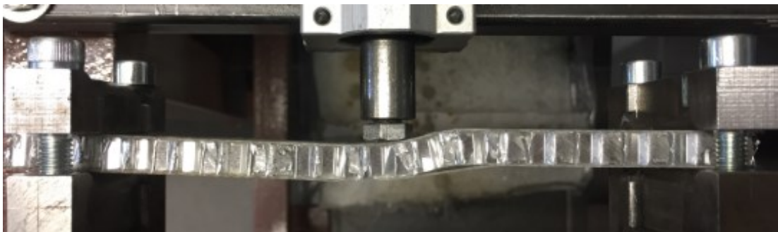
Obr. 59. Porucha sendviče s potahem ze skelného prepregu na 3. hladině zatížení
