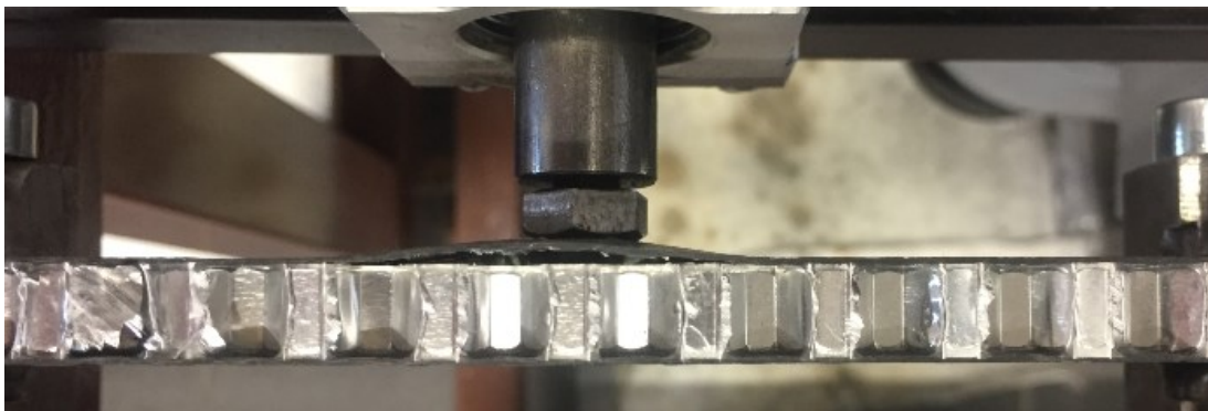
Obr. 56. Porucha sendviče s potahem z uhlíkového prepregu na 1. hladině zatížení
