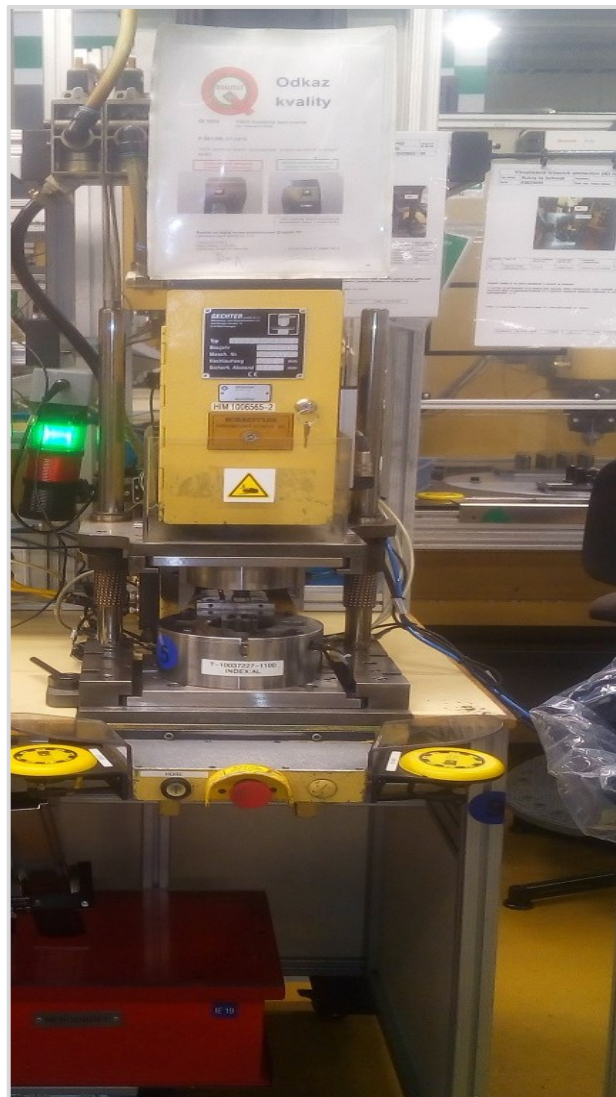
Obr. č. 28 - Pneumatický lis
