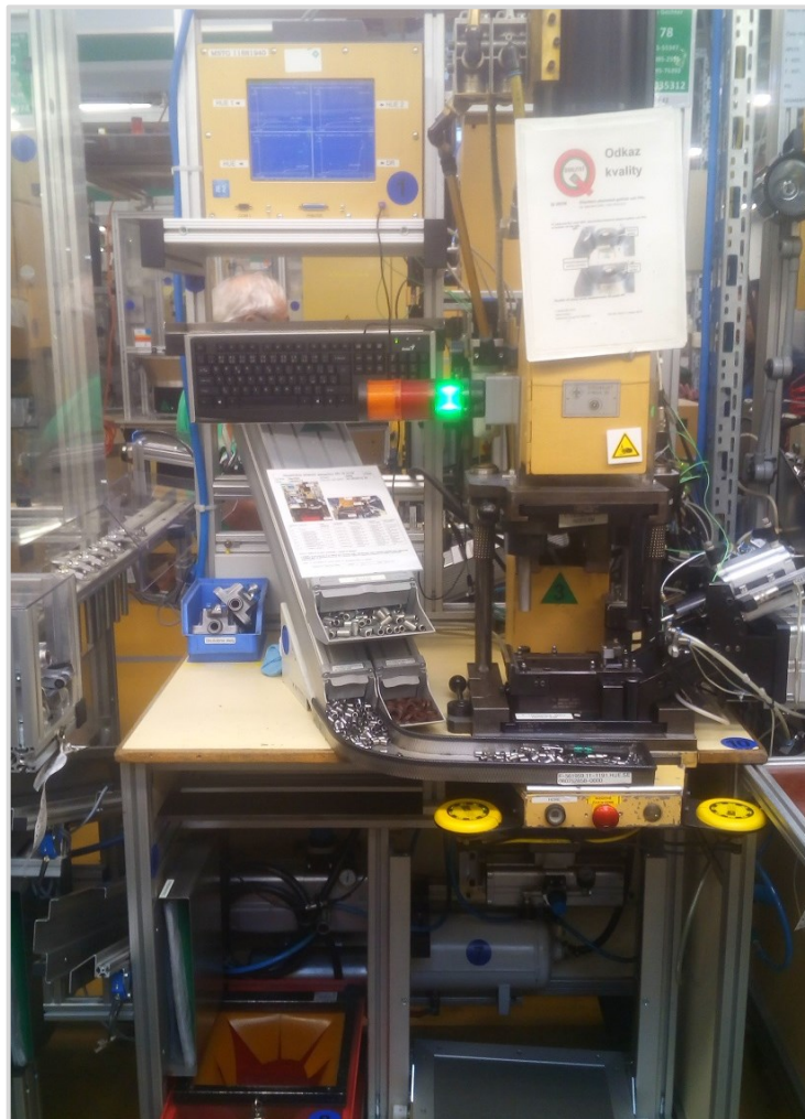
Obr. č. 52 - Pneumatický lis
