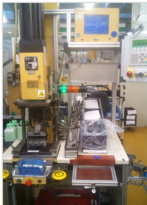
Obr. č. 58- Pneumatiký lis
