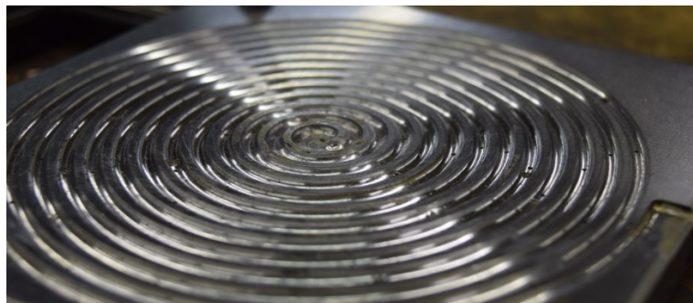
Obr. 17 Spirálová zkušební forma pro termoplastické vstřikování
