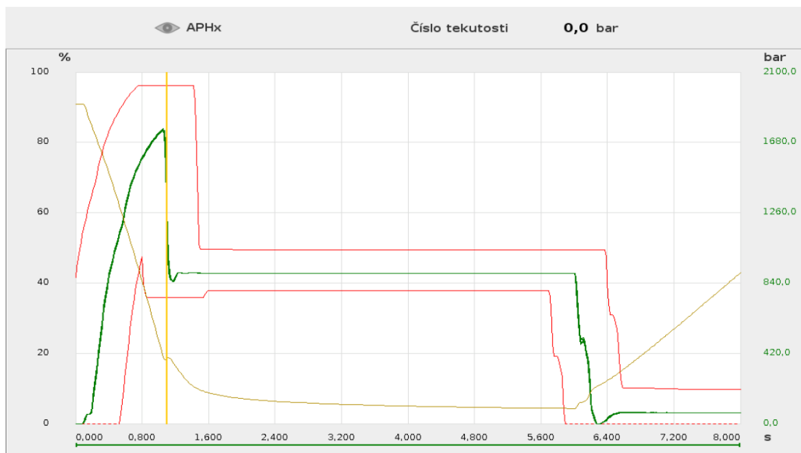
Obr. 44 Micrograf průběhů tlaků během vstřikování pro skupinu o teplotě 0°C
