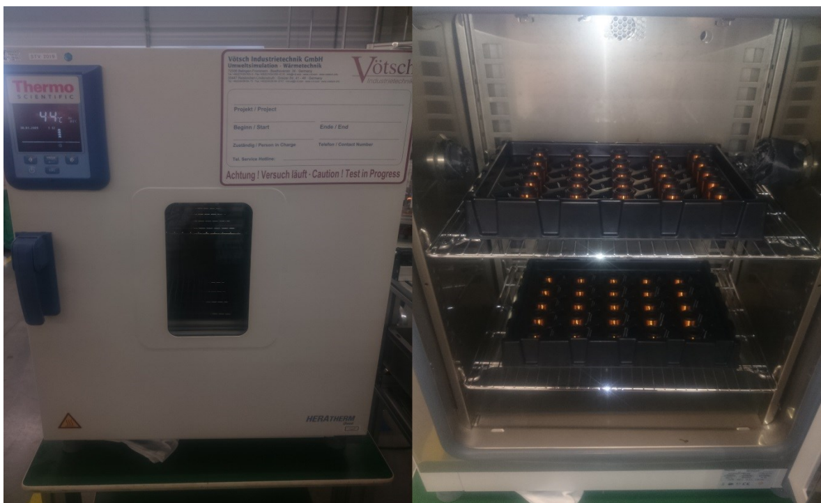
Obr. 43 Nalevo teplotní komora; napravo cívky uloženy v komoře
