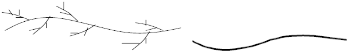
Obr. 8 Molekulární struktura plastů. Rozvětvená struktura vlevo, lineární struktura vpravo [8]
