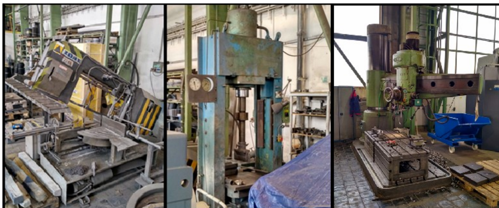
Obr. 33 Pila, hydraulický lis radiální vyvrtávačka VR8 (vlastní zpracování)
