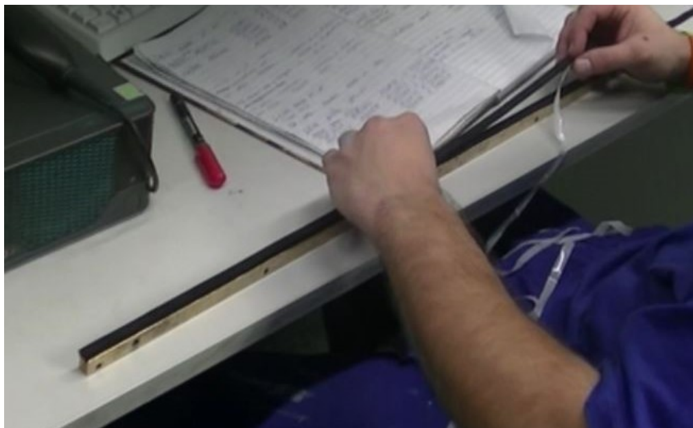
Obr. 38. Přelepení původní dvouvrstvé gummy na mechovce (vlastní zpracování)
