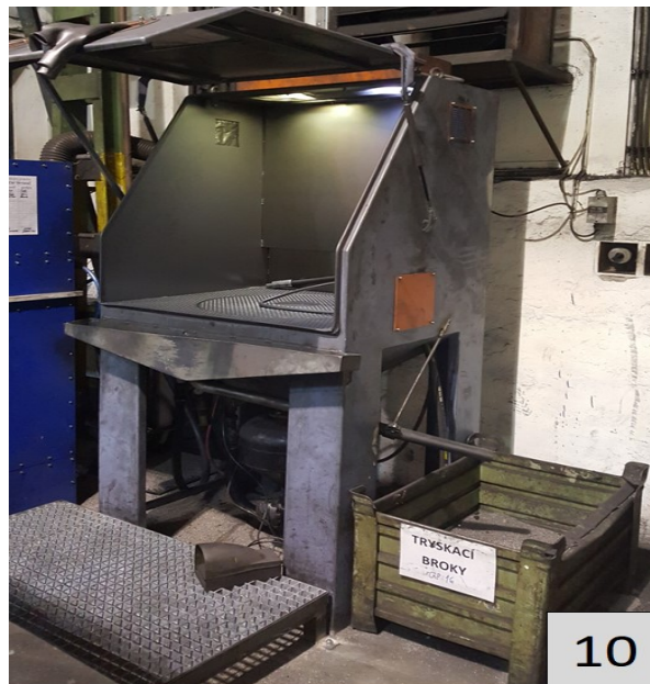
Obrázok 51 Ručné tryskacie zariadenie na výkoveky (vlastné spracovanie)
