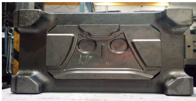
Obrázok 17 Ukážka držiaku a vlozenej zápustky (vlastné spracovanie)
