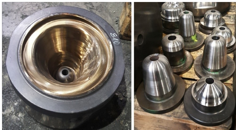
Obrázok 47 Ukážka zápustky s vloženým tvarovým pupkom a nových tvarových pupkov (vlastné spracovanie)
