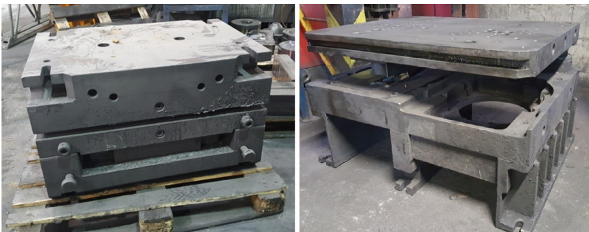
Obrázok 50 Ukážka veľkého držiaku na tvarové náradie a veľkého ostrihovacieho univerzálu (vlastné spracovanie)
