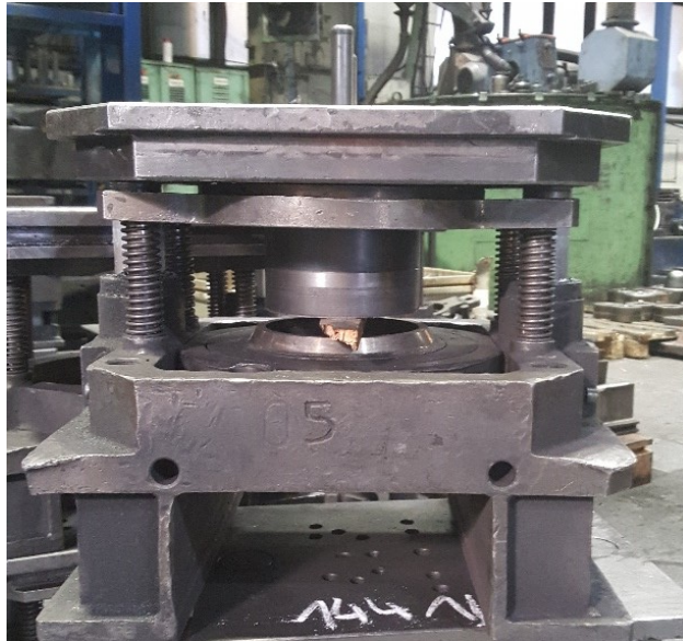
Obrázok 42 Ukážka pripraveného malého ostrivacieho univerzálu (vlastné spracovanie)
