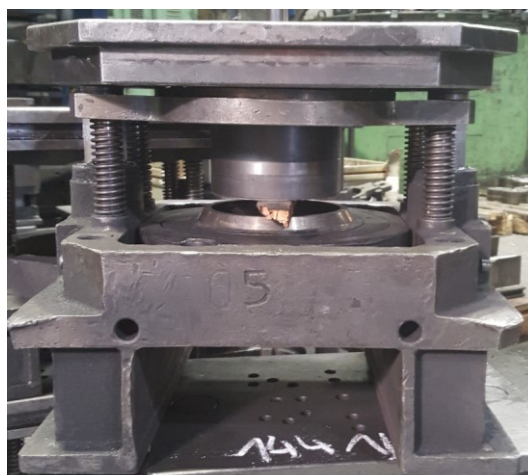
Obrázok 21 Odstrieňovacie náradie (vlastné spracovanie)
