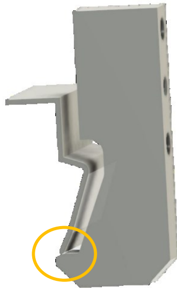
Obrázek 24 – Model poškozeného chapače na AP2 (vlastní zpracování)
