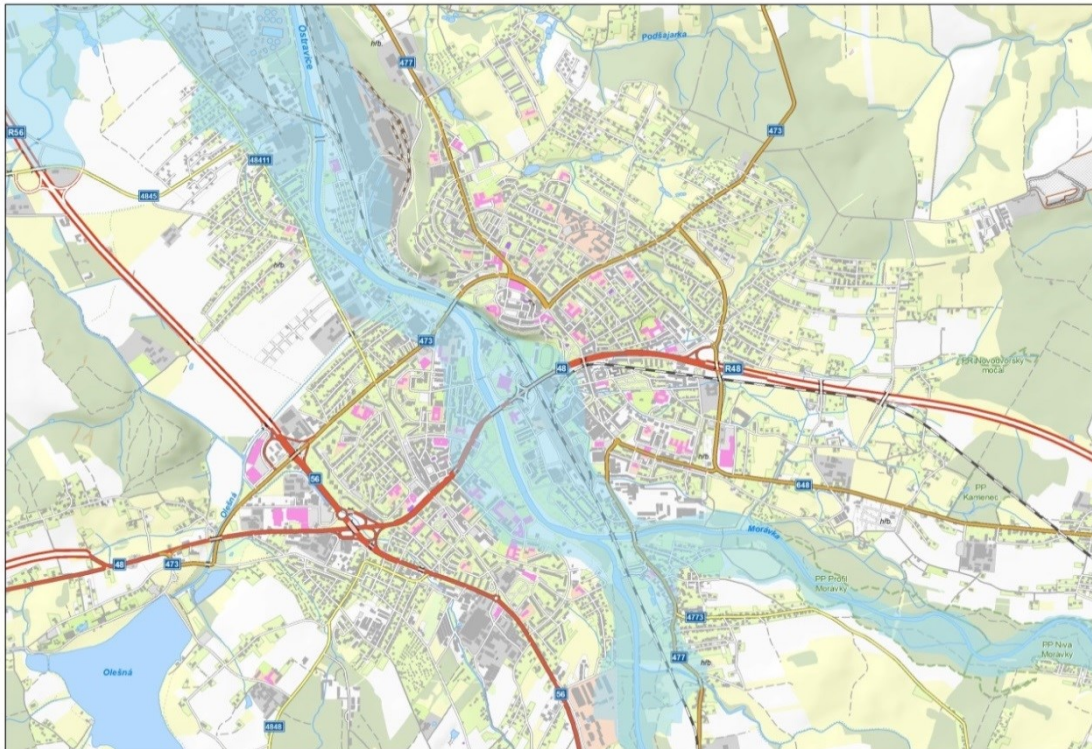
Obrázek 5 - Model záplavové oblasti při přívalové povodni (GIS)
