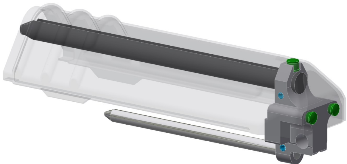
Obr. 42 3D model originální sestavy nosiče pružin a jejich os přinýtovaný ke krytu závěru
