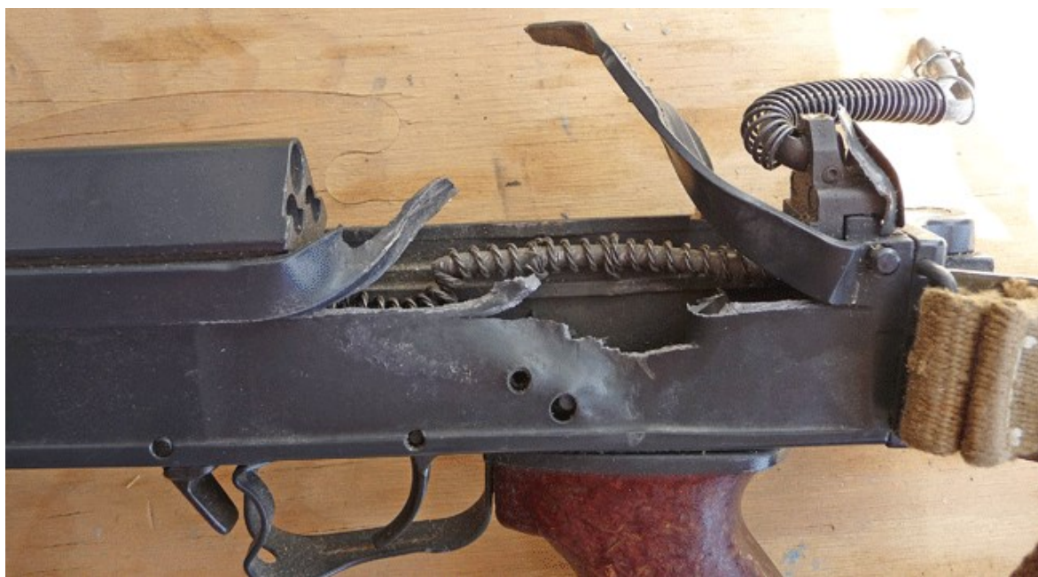
Obr. 16 Roztržení rámu zbraně způsobené nejspíše kombinací několika faktorů naráz: silného zanešení, horkého prostředí a déle trvající nepřerušované střelby. Takovýto rozsah poškození je však u Sa vz. 58 naštěstí velmi vzácný.
