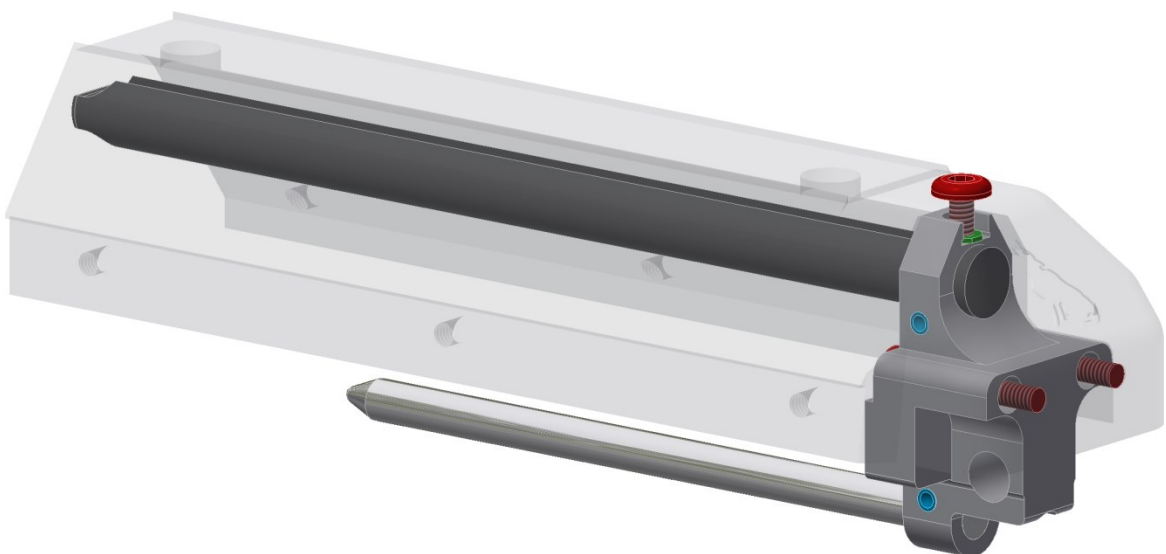
Obr. 45 3D model originální sestavy nosiče pružin a jejich os spojený s novým krytem závěru pomocí tří šroubů M3 na imbus 2.5 mm
