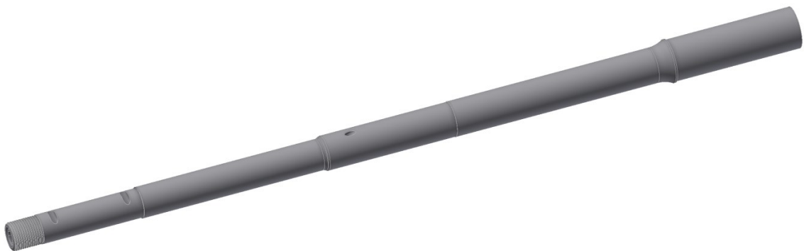
Obr. 12 3D model hlavně - patrný závit pro cvičný nástavec a kanálek pro odvod plynů (závit na začátku hlavně u komory není zobrazen)
