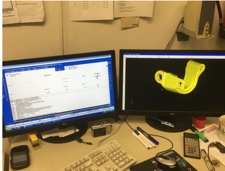
Obr. 16 – Měření vyděrovaných dílců
