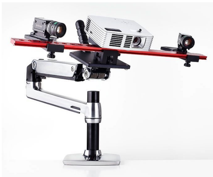
Obr. 14. Optický 3D skener [13]
