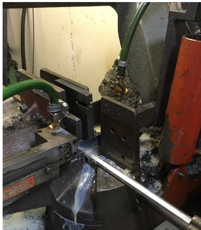
Obr. 36. Řezání šestihranné tyče na délku 240 mm
