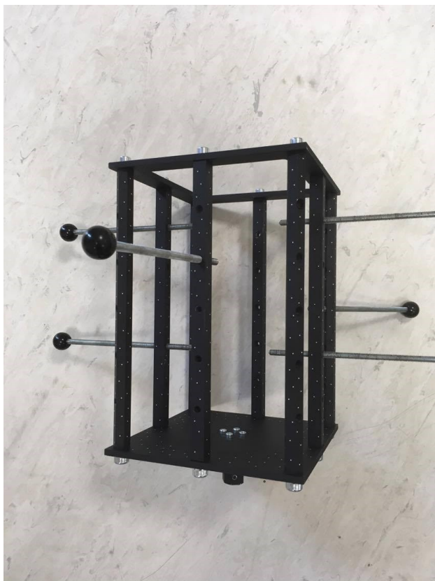
Obr. 38. Rámeček po povrchové úpravě a polepení referenčními body
