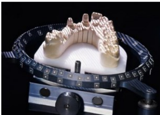
Obr. 5. 3D optické skenování odlitku zubů [8]
