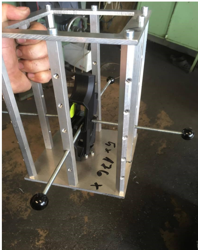
Obr. 37. Sestavení rámečku před povrchovou úpravou + zkouška upnutí
