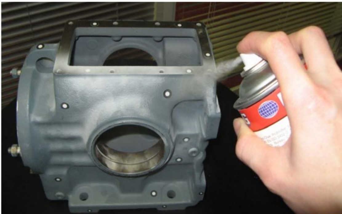
Obr. 18. Zmatnění povrchu pomocí křídového spreje
