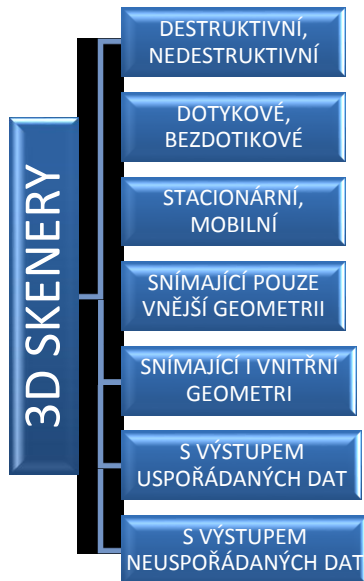
Obr. 12. Rozdělení 3D skenerů [12]
