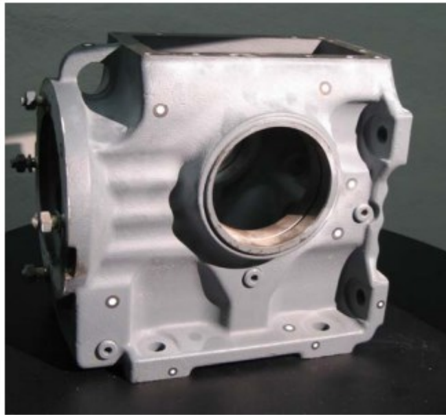
Obr. 17. Aplikace referenčních bodů na skenovaný dílec
