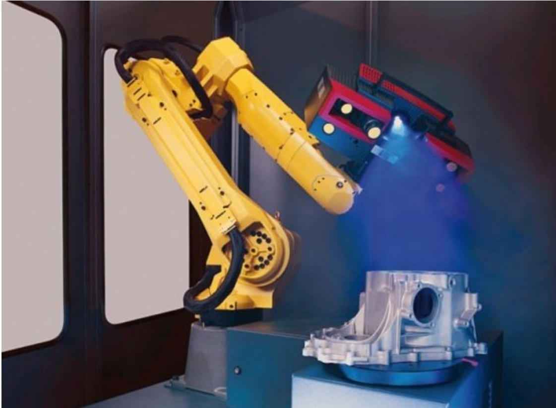
Obr. 16. Optický 3D skener ATOS
