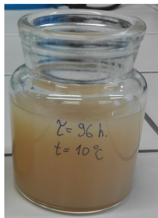
Obrázek č. 17: Barva vzorku klišu pro dobu síťující reakce 96 h při teplotě 10 °C
