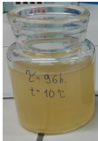
Obrázek č. 20: Barva vzorku želatinového gelu po síťující reakci 96 h a teplotě inkubace 10 °C
