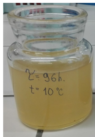
Obrázek č. 24: Barva vzorku želatinového gelu po síťující reakci 96 h a teplotě inkubace 10 °C
