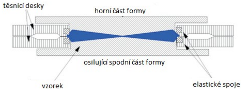
Obrázek 19: Schéma pracovní části přístroje RPA 2000 [46]
