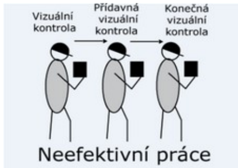
Obrázek 13 Nadbytečná práce (Plýtvání, © 2012)
