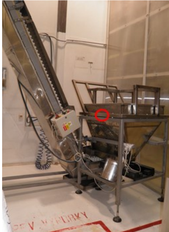
Obrázek 50 Navržené umístění nového čidla v násypce (vlastní zpracování)
