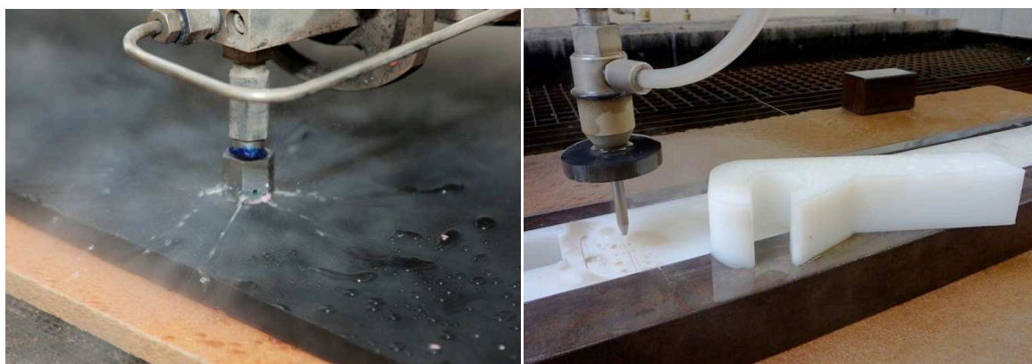
Obr. 9 Detail řezu vodním paprskem
