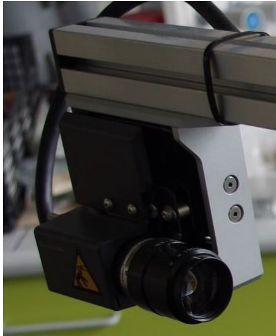
Obrázek č.33 Videoextensometr zkušebního stroje Shimadzu AG-CC 50kN
