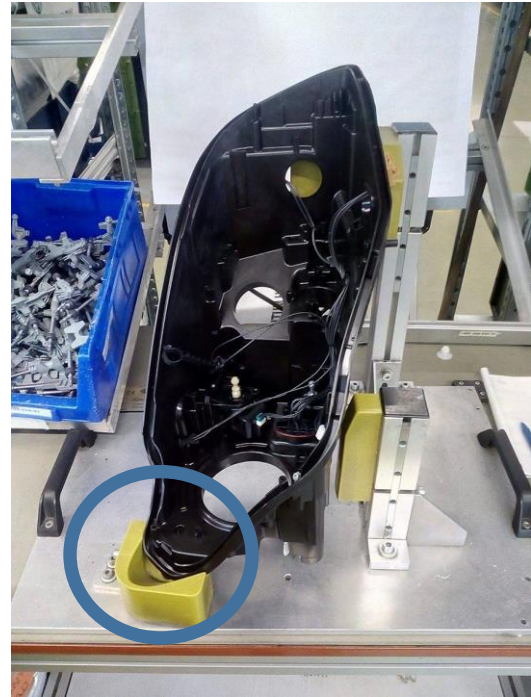
Obrázek 32 Usazení pouzdra do obou přípravků 240 (napravo) a 230 (nalevo)
