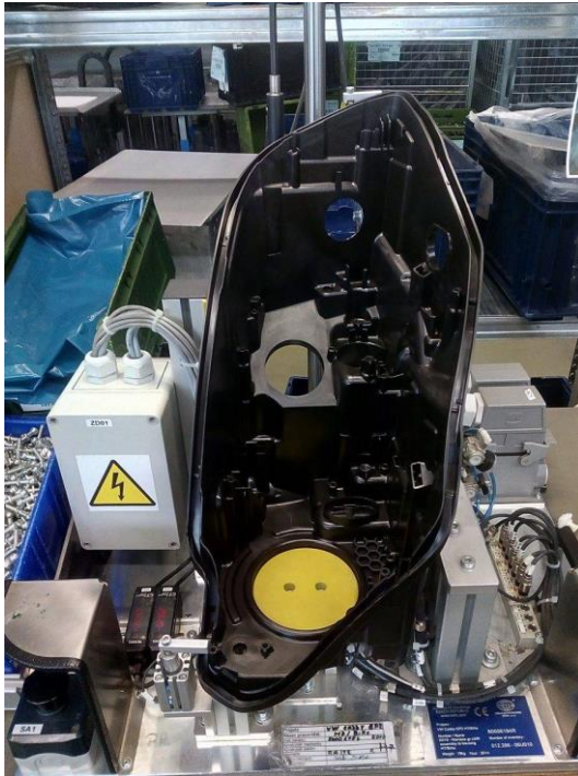
Obrázek 32 Usazení pouzdra do obou přípravků 240 (napravo) a 230 (nalevo)
