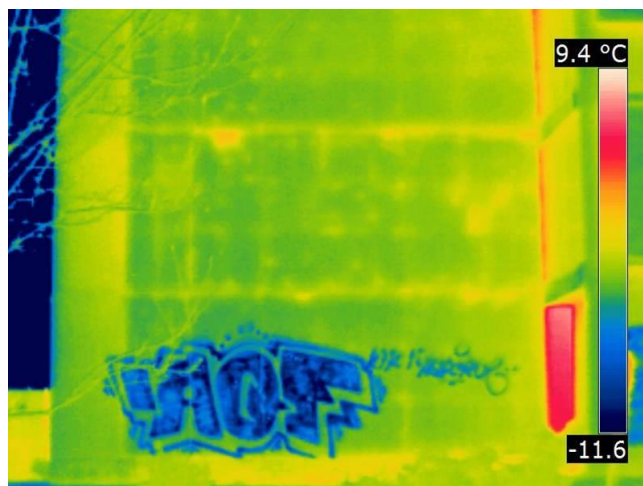
Obrázek 3 Ukázka odlišné emisivity měřeného objektu [8]
