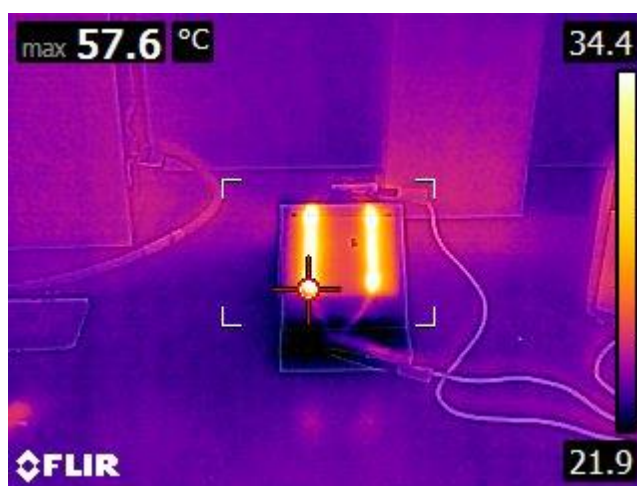
Obrázek 16 Termogram testovacího zařízení č. 2 (snímaná vzdálenost 1m)
