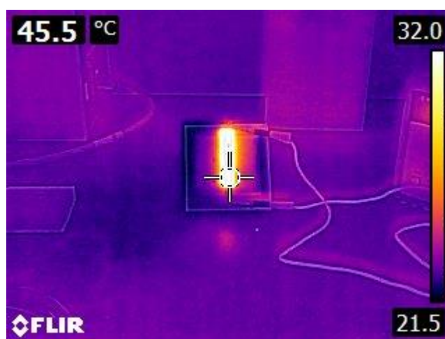
Obrázek 13 Termogram testovacího zařízení č. 1 (snímaná vzdálenost 30 cm)
