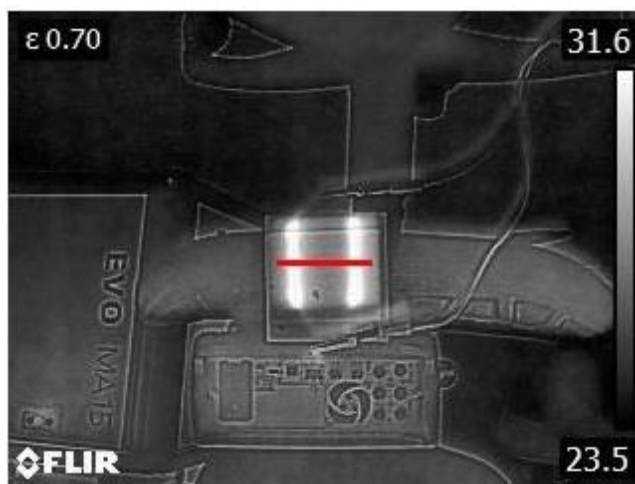
Obrázek 18 Vybraná část obrazu pro vyhodnocení kontrastu (snímaná vzdálenost 60 cm)
