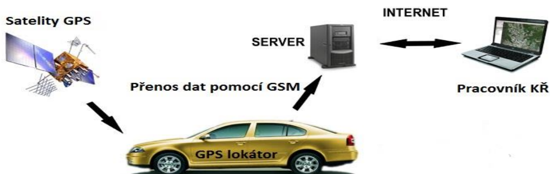
Obrázek 17 Systém přenosu dat GPS [24]
