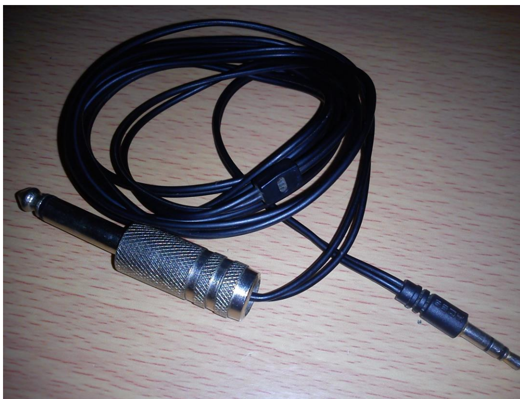
Obrázek 36 – Propojovací redukce mono JACK 6,3mm – stereo JACK 3,5mm
