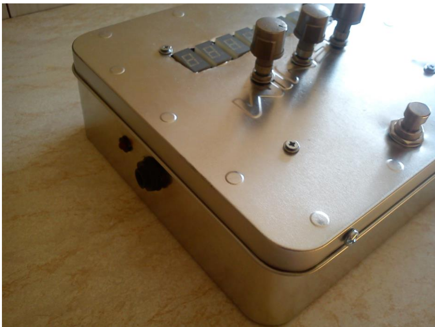
Pohled zleva na výstupní JACK a červenou LED indikující clipping výstupního D/A převodníku
