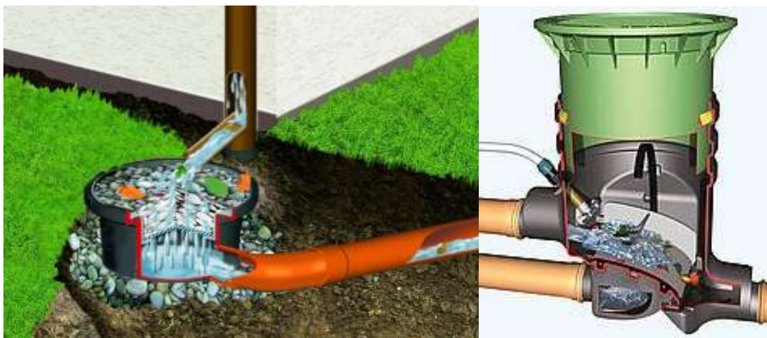
Obr. 24: Filtrační nátoková šachta a samočistící šachtový filtr[23]
