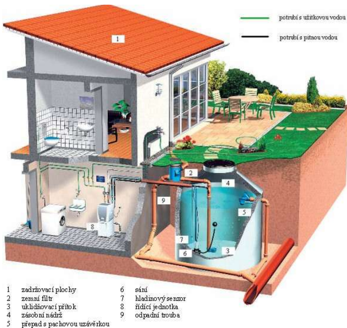
Obr. 8: Příklad systému na využití dešťové vody, včetně domovních rozvodů [22]
