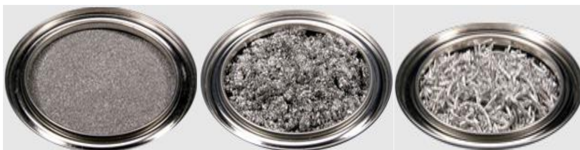
Obr. 12. Alternativy výrobků – prášky, pasty, granulát (interní materiály společnosti)
