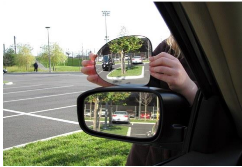
Obr. 5 Tvarované odrazové sklo pro lepší přehlednost za vozidlem. [8]
