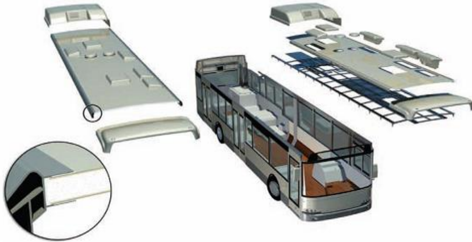
Obr. 9. Sendvičová konstrukce střechy autobusů[8]
