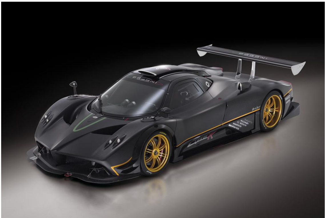
Obr. 10. Pagani Zonda – velké využití sendvičových pevnostních struktur a laminátových krycích panelů [19]
