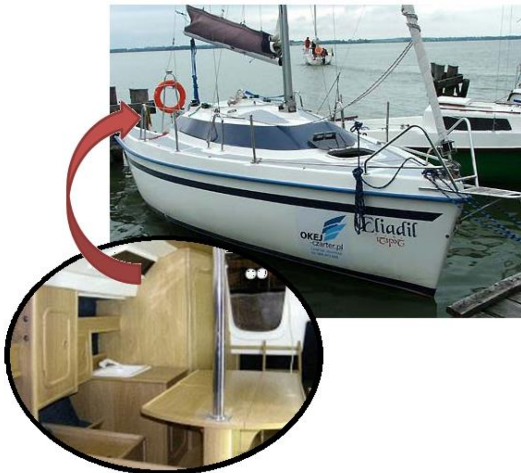
Obr. 8. Plachetnice Derek 26; trup i paluba ze sendvičové konstrukce [15]
