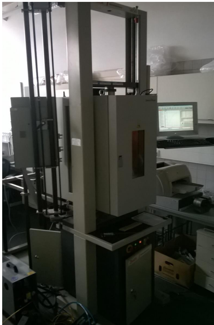
Obr. 37. Stroj Zwick 1456 a teplotní komora Zwick W91255
