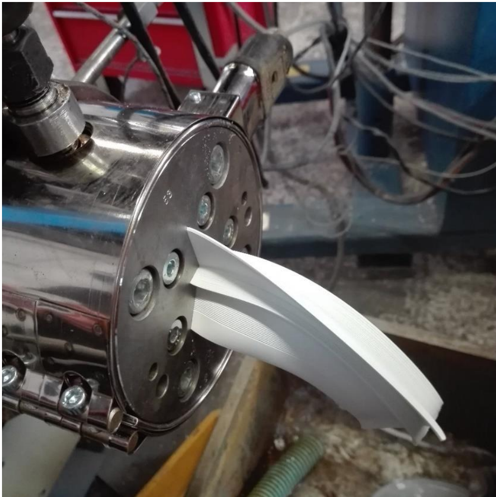
Obr. 81 Začátek vytlačování profilu
