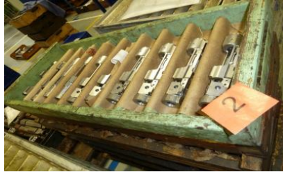
Obr. 22 Drevené prevedenie uloženia lôžok (Vlastné spracovanie)
