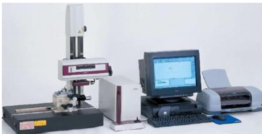
Obr. 41. Schéma dotykového profiloměru [19]
