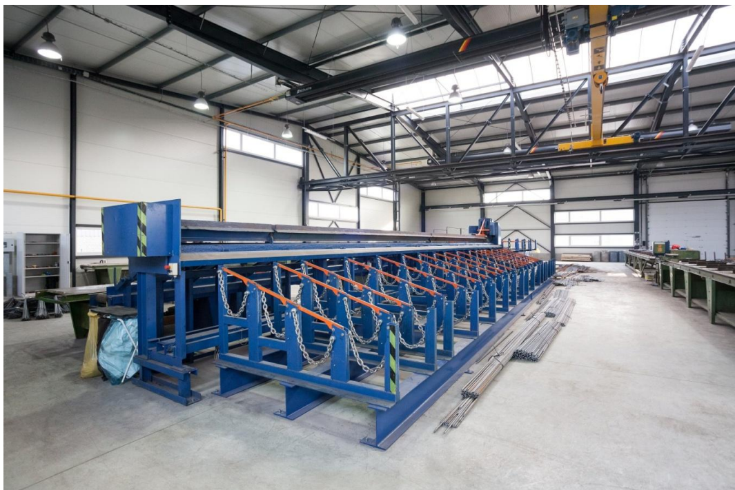
Příloha 8: Stříhačka ocelových prutů Pedax Combiline
