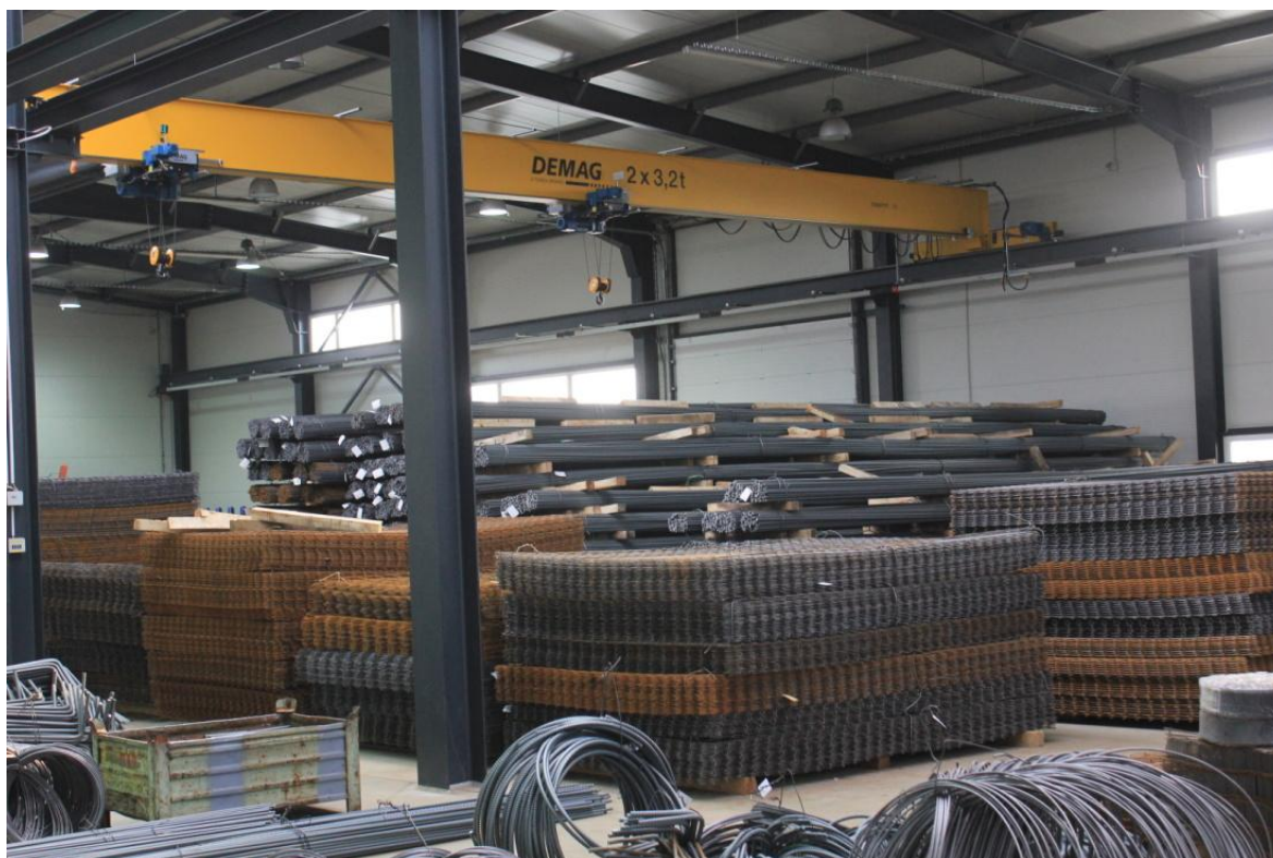
Příloha 6: Skladová část s pruty a kari sítěmi
