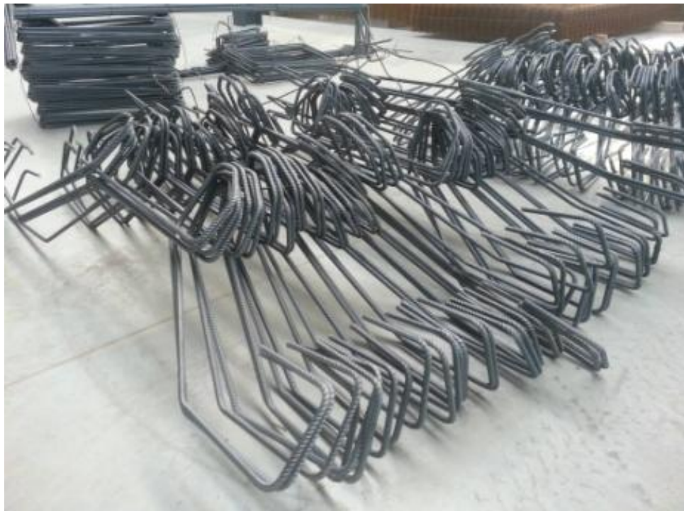
Obrázek 15: Příklad tvarově náročných ohybů výztuže s požadovanou přesností v sériích (Mach)
