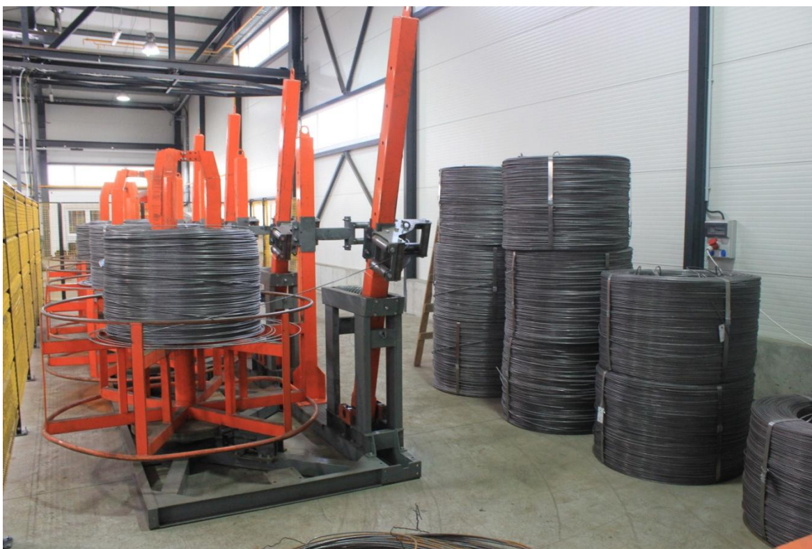
Příloha 10: Odvíječ oceli pro třmínkovačku ze svitků
