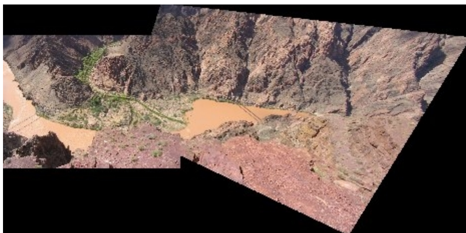
Obr. 5: Spojení dvou snímků na základě výpočtu klíčových bodů algoritmem SIFT [7]
