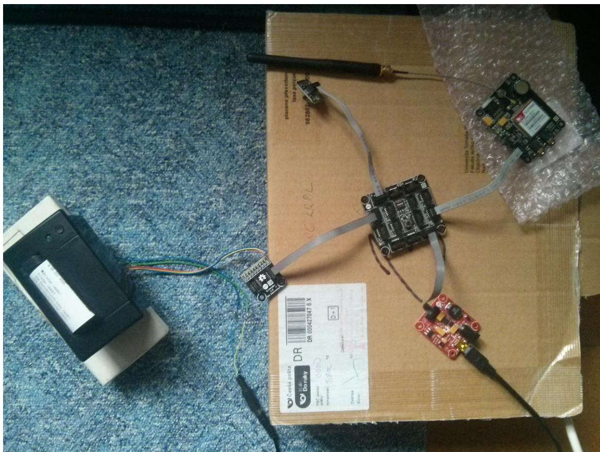
Obrázek 9 – Zapojení desky a příslušných modulů ve skutečnosti
