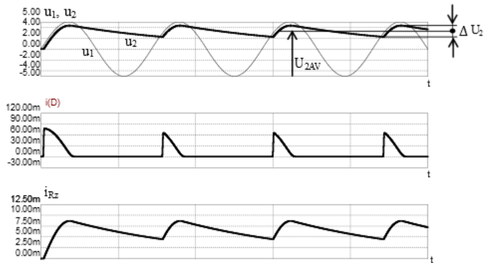
Obrázok 8: Jednofázový usmerňovač s kapacitným charakterom záťaže [1]
