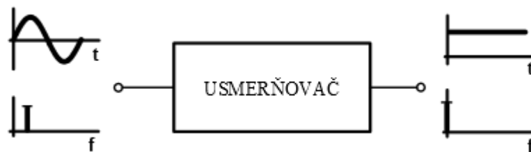
Obrázok 4: Schematické znázornenie ideálneho usmerňovača [1]
