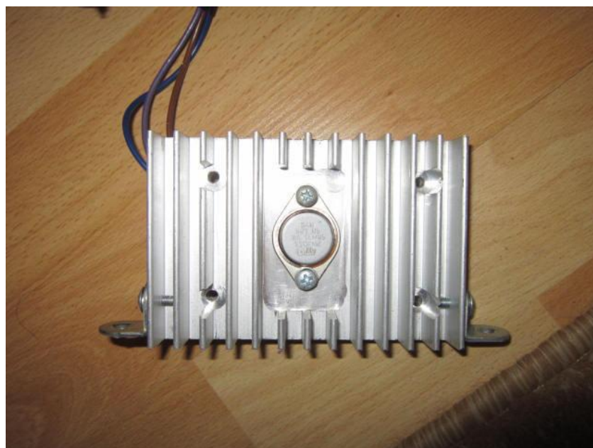
Obrázok 38: Osadenie tranzistoru na pasívne chladenie
