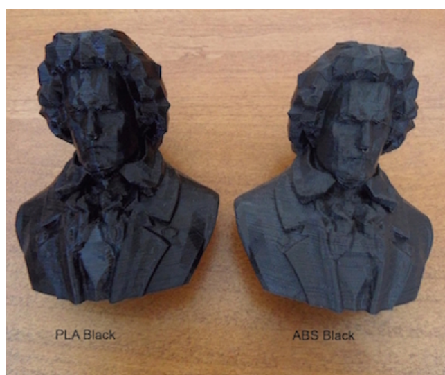
Obr. 1.7 Porovnání ABS a PLA u vytištěného modelu [19].
