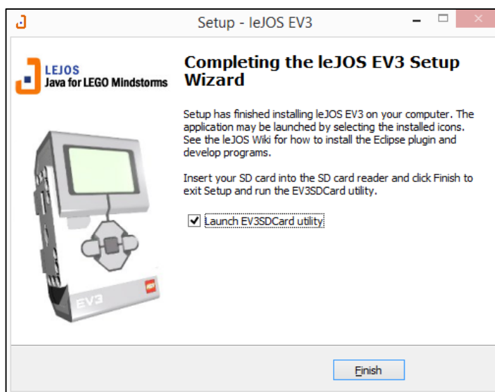
Obrázek 27: Konec instalace, zaškrtnutím políčka Launch EV3SDCard utility zajistíme spuštění programu pro nastavení microSD karty.
