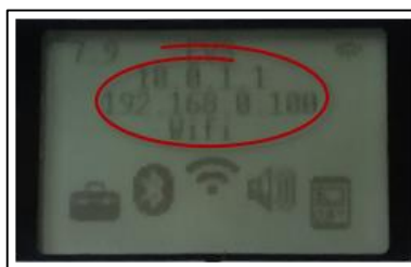
Obrázek 36: Po připojení Bricku do sítě se IP adresa zobrazí na hlavní obrazovce.
