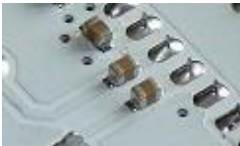
Obrázek 34 – Detail pájení SMD součástek
