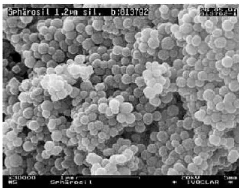
Obrázek 10. Snímek vnitřní struktury siliky [14]
